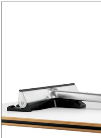
Herzstück von mAx ist die patentierte, selbststabilisierende Klappmechanik. Beim Ausklappen des T-Fußgestells schiebt sich die integrierte Stützstrebe aus dem Säulenprofil heraus und verkeilt das Tischgestell im 90°-Winkel zur Tischplatte. Der besondere Clou: Durch die ansteigende Verkeilungsbahn wird die Verbindung immer fester, je mehr am Tisch gerüttelt wird. Beim Aufstellen des Tisches wird eine Sicherung aktiviert, die das unbeabsichtigte Einklappen während der Tischnutzung verhindert.
