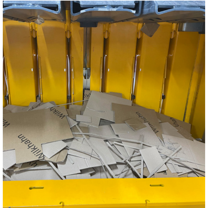
Am Wilkhahn-Stammsitz werden Abfälle möglichst sortenrein getrennt und dem Recycling zugeführt. Folien und Pappen werden zu Ballen kompaktiert, um Transportemissionen zu reduzieren.
