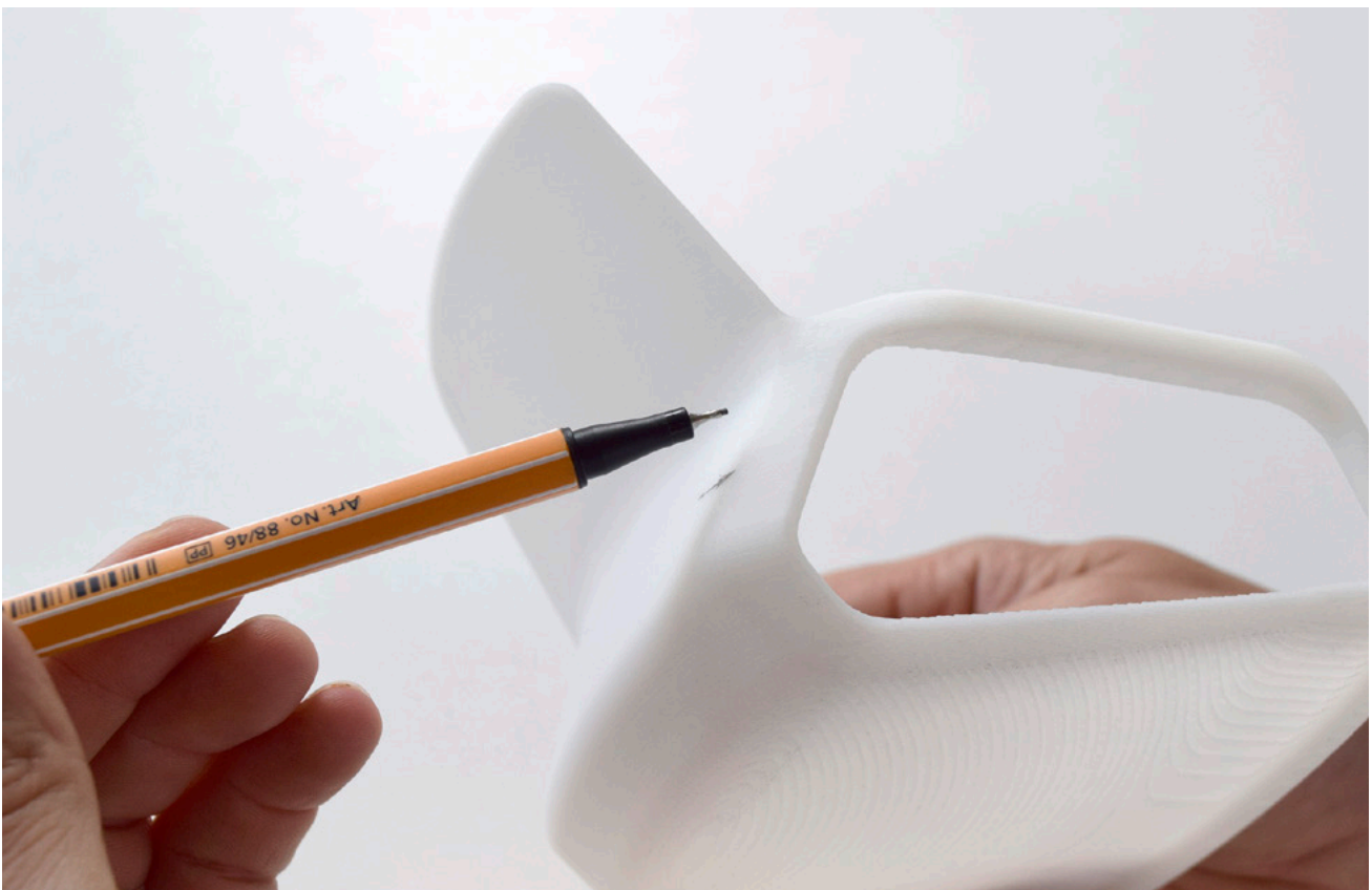
Aller Arbeit am Bildschirm im Entwurfs- und im Entwicklungsprozess zum Trotz: Die ästhetische Optimierung erfolgt anhand von Modellen, die beispielsweise als 3-D-gedruckte Objekte im Laser-Sinterverfahren hergestellt werden.
