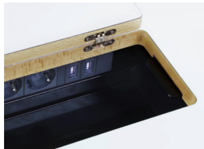
Der Zugang zu den vier Steckfeldern und der Kabelwanne erfolgt über hochwertige flächenbündig eingearbeitete Einbauklappen. Zwei Stromanschlüsse, eine Buchse mit zwei USB-Anschlüssen zum Aufladen mobiler Endgeräte und ein Reservesteckplatz zur variablen Bestückung lassen kaum Wünsche offen (Einsätze seriell in Ausführungen nach deutschem, französischem und britischem Standard verfügbar).
