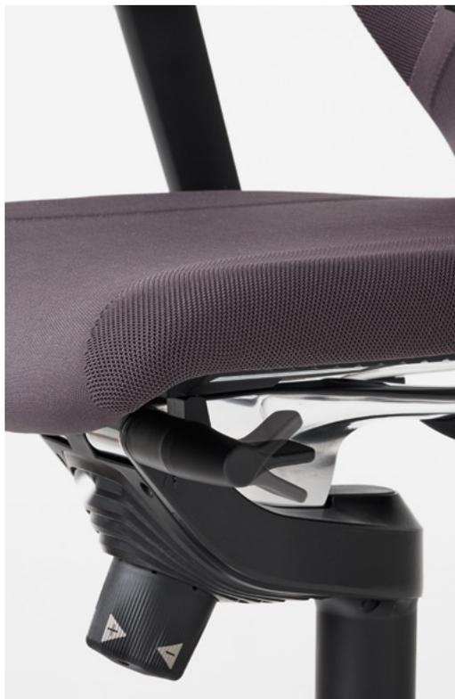
IN : une molette en position centrale sous l'assise assure le réglage de la force de rappel selon le gabarit de l'utilisateur (45 – 140 kg). Une manette latérale assure le blocage du dossier en position de travail et l'inclinaison vers l'avant (en option).
