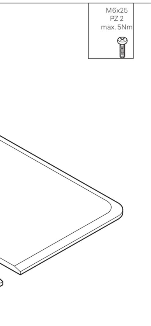
Den Stapelring um die Tischträgerplatte ausrichten (1) und mit Schrauben und Unterlegscheiben an der Tischplatte verschrauben (2).
