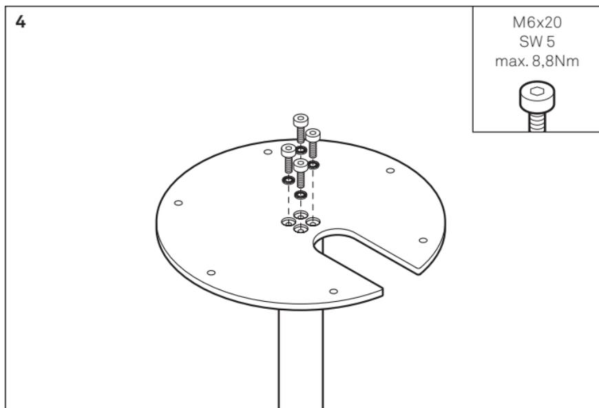
Standsäule mit der Tischträgerplatte verschrauben (3, 4).
