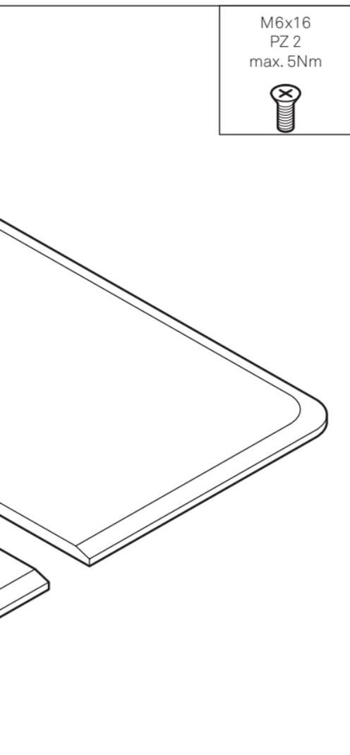
Gestell mit der Tischträgerplatte auf der Unterseite der Tischfläche verschrauben.
